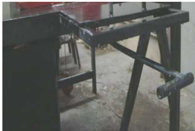
الشكل (10) ذراع التحكم بفتح وإغلاق فتحة المخرج
